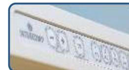
Tastiera frontale dotata di cinque tasti funzione, led di stato, controllo luminosità pannello lcd e disabilitazione funzione touchscreen.
